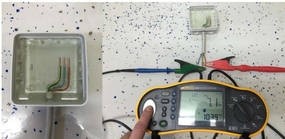
**Isolationswiderstand bei 1000V Prüfspannung direkt nach Verguss >7,1MOhm**
